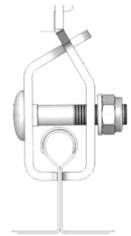
Zur Sicherung der Ringschraube ist unbedingt hochfeste Schraubensicherung (z.B. Loctite) zu verwenden. Ringöse aufsetzen und rechts herum mit der Mutter M16 (inkl. Unterlegscheibe DIN 9021-17 und Federring-A 16) verschrauben, bis sie vollflächig auf der Stirnfläche der Befestigungsschiene aufliegt.
