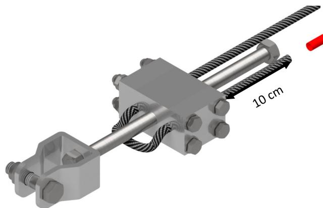
Nach der Montage der Seilklemme am Edelstahlseil, die Seilklemme Typ A am Kraftabsorber befestigen. Lösen Sie oben an der Gabelaufnahme die selbstsichernde M12 Mutter und führen die Ringöse des Kraftabsorbers durch die M12 Schraube und schrauben Sie diese mit der selbstsichernden Mutter fest.
