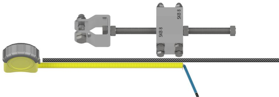
Zum Spannen des Seils drehen Sie die am unteren Ende der Gewindestange angeschweißte Mutter im Uhrzeigersinn, bis am Spannelement 3cm - 4cm Federweg ausgefahren sind. Benutzen Sie nach dem Spannen die angebrachte Kontermutter zum fixieren der Seilklemme. Schrauben Sie dazu die Kontermutter fest gegen den Alu-Block.
