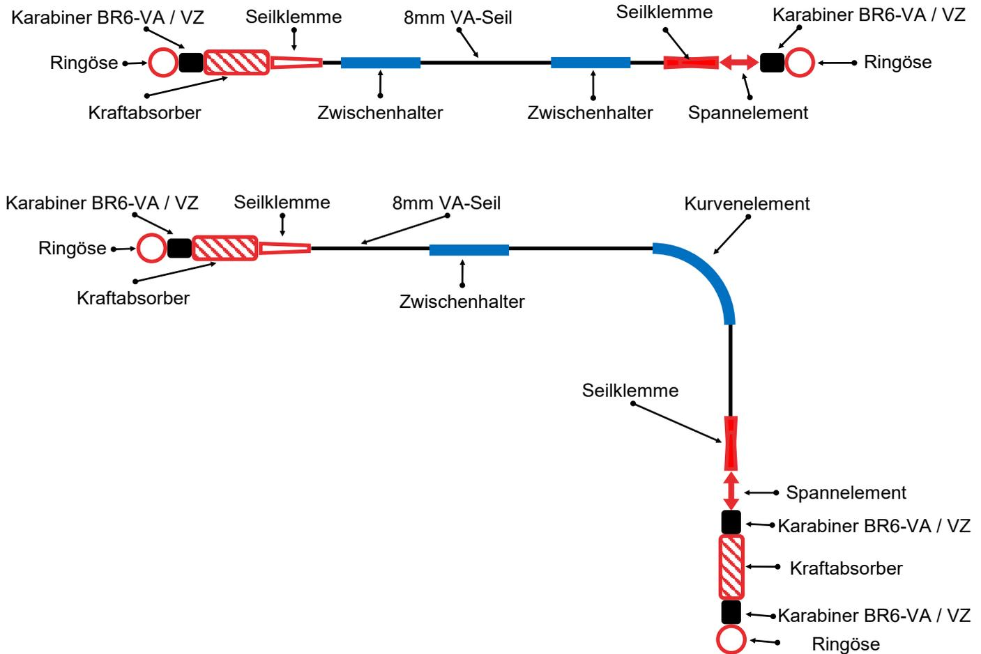
Montieren Sie die zweite Seilklemme am Spannelement (oder Kraftabsorber je nach Aufbausituation) mittels lösen und anschließenden handfestem anziehen der M12 Mutter an der Gabelaufnahme.
