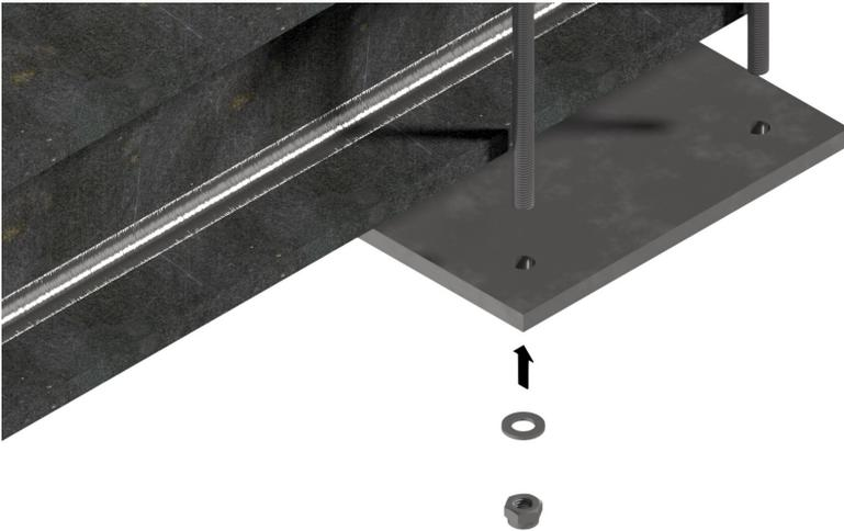
Den Primo 50 ST über den Stahlträger stecken. Der Stahlträger muss mittig zwischen den Gewindestangen verlaufen.
