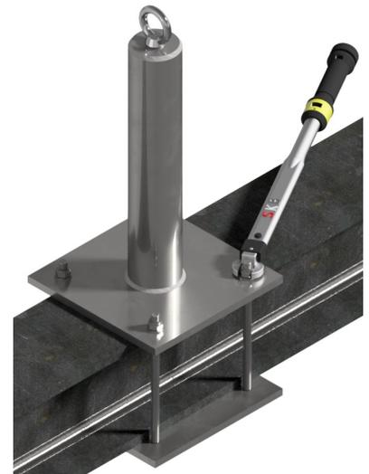
Mit einem Drehmomentschlüssel rechts herum eindrehen und an jeder Gewindestange mit 70,5 Nm festziehen.
