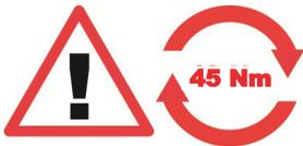
Achten Sie darauf, dass die Bolzenanker fest mit dem Untergrund verbunden sind. Anzugsdrehmoment unbedingt einhalten!
