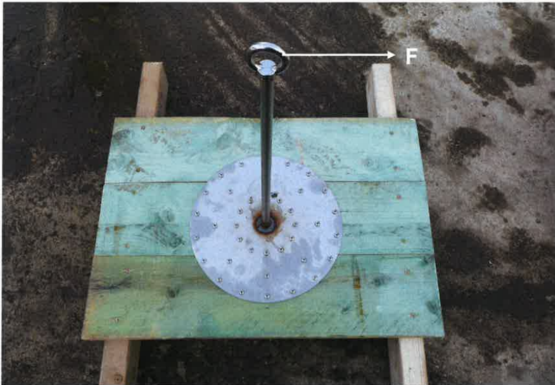
Bild 2: Prüfanordnung der Anschlagereinrichtung, Typ: PRIMO 20 HU mit der Richtung der eingeleiteten Kraft F
