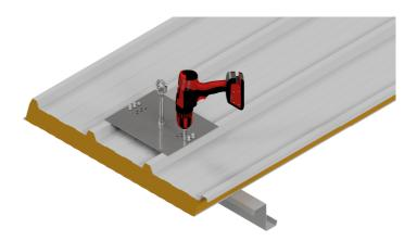
4. Platzieren Sie die Anschlageinrichtung wieder auf den Sandwichpaneelen. Bohren Sie mit den Bohrschrauben durch die Dichtung und durch das Deckblech der Sandwichpaneele durch die jeweils 10 passenden Löcher auf jeder Seite der Anschlageinrichtung.
