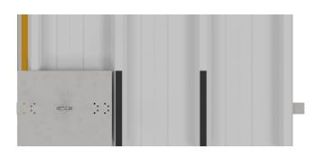
3. Kleben Sie die zweite mitgelieferte Dichtung im Bereich der Anschlageinrichtung auf die benachbarte Hochsicke der Sandwichpaneele.
