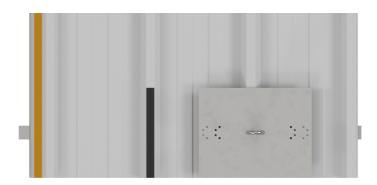
1. Platzieren Sie die Anschlageinrichtung an der gewünschten Stelle auf den Sandwichpaneelen (Mittig vom Stahlträger).
