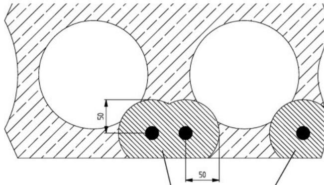
Der Dübel muss einen Mindestabstand von der Dübelachse zur Spannlitzenachse von 50 mm einhalten. Je nach Ausführung können die Spannlitzen auch oben sitzen. Dies ist vorher abzuklären.
