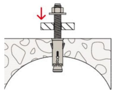
Nun die Sechskantschraube M10 x 80 DIN 933 mit Unterlegscheibe 10,5 DIN 9021 in die Hülse eindrehen und den SRB SP-HO Seilzugang befestigen.
