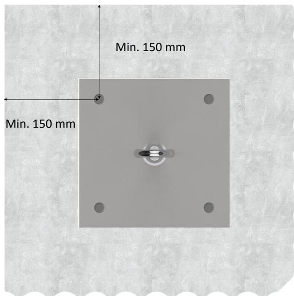
Die Anschlagereinrichtung sollte grundsätzlich gemäß DGUV Regel 201-056 in einem Abstand von mindestens 2,5 m zur Absturzkante montiert werden. Der Abstand zwischen den Anschlagereinrichtungen darf bei Seilsystemen 10 m nicht überschreiten. Bei Einzelanschlagpunkten sollte der Abstand zwischen den Anschlagereinrichtungen 7,5 m nicht übersteigen.
