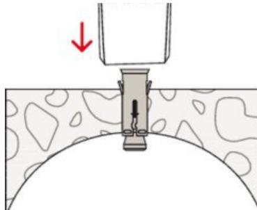
Den Hohldeckenanker FHY von Hand ins Bohrloch einsetzen und mit dem Hammer bündig zur Oberfläche des Verankerungsgrunds eintreiben.
