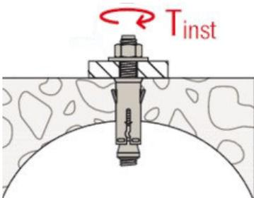
Zuletzt die Schrauben mit einem Anzugsdrehmoment von **20 Nm** anziehen.
