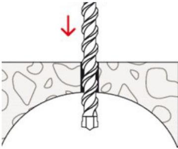
Die vier Bohrlöcher  $\varnothing 16$  mm rechtwinklig zur Betonoberfläche min. 65 mm in den Beton bohren. Löcher ggf. ausblasen
