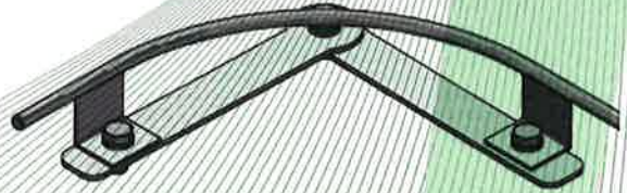
Bild 16: Eckverankerung, Typ: Kurve 3 überfahrbar
