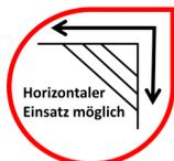
Das festvernähte Verbindungsmittel ist für einen Sturz über eine Kante und den daraus resultierenden horizontalen Einsatz in Kombination mit dem Bandfalldämpfer BFD der Sicherheitskonzepte Breuer GmbH zugelassen.
