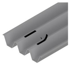
Kleben Sie die mitgelieferte Dichtung im Bereich der Anschlageinrichtung auf die Hochsicke des Trapezblechs.
