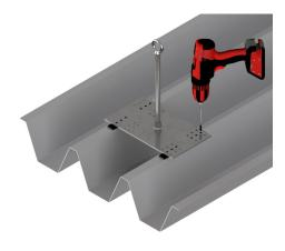
Platzieren Sie die Anschlageinrichtung wieder auf dem Trapezblech. Bohren Sie (Ø 7,8 mm) durch die Dichtung und durch das Deckblech des Trapezblechs durch die jeweils 3 passenden Löcher in jeder Ecke der Anschlageinrichtung.
