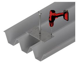
Bohren Sie (Ø 7,8 mm) durch das Deckblech des Trapezblechs durch die jeweils 3 passenden Löcher in jeder Ecke der Anschlageinrichtung.
