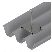
Befestigen Sie die Anschlageinrichtung mit den 12 mitgelieferten Nieten auf dem Trapezblech.
