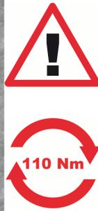
8. Das Gewinde des Bolzenankers muss nach dem Festziehen min. 40 aus der Betonoberfläche ragen. Ragt das Gewinde mehr als 70 mm raus, kann der Dübel nicht mehr verwendet werden.
