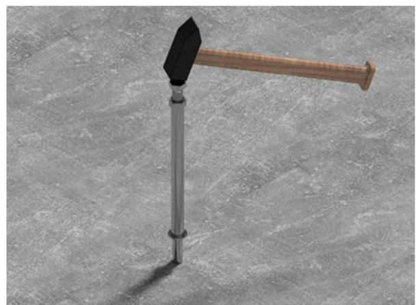
7. Das Rohr an der Setzhilfe mit 110 Nm rechts herum festziehen.
