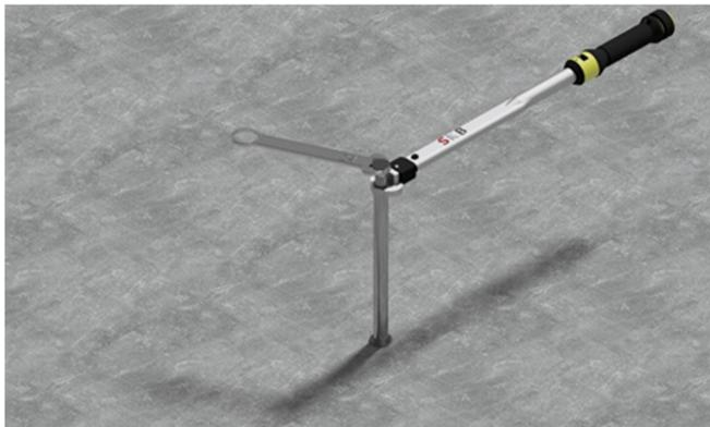
10. Zur Sicherung der Ringschraube ist unbedingt Schraubensicherung (z.B. Loctite) zu verwenden. Ringöse aufsetzen und rechts herum eindrehen, bis sie vollständig auf der Stirnfläche des Rohres aufliegt.
