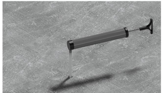
5. Die Setzhilfe in das obere Gewinde der Stütze eindrehen. Kontrollieren Sie, dass der Dübel von der Unterseite der Unterlegscheibe aus ca. 103 mm ( $h_{nom}$ ) aus dem Rohr ragt.
