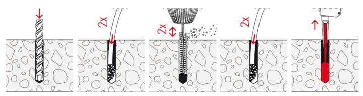
Die 4 Bohrlöcher ø 18 mm rechtwinklig zur Betonoberflache 160 mm tief in den Beton bohren. Staub von der Oberfläche entfernen (z.B. mit Handfeger) und Bohrlöcher 2 mal ausblasen. Die Bohrlöcher sind mit der Reinigungsbürste 2 mal auszubürsten. Erneut Staub von der Oberfläche entfernen (z.B. mit Handfeger) und Bohrlöcher 2 mal ausblasen. Die Bohrlöcher sind jeweils mit ca. 30 ml des Spezialmörtels FIS HB 345 S zu füllen.
