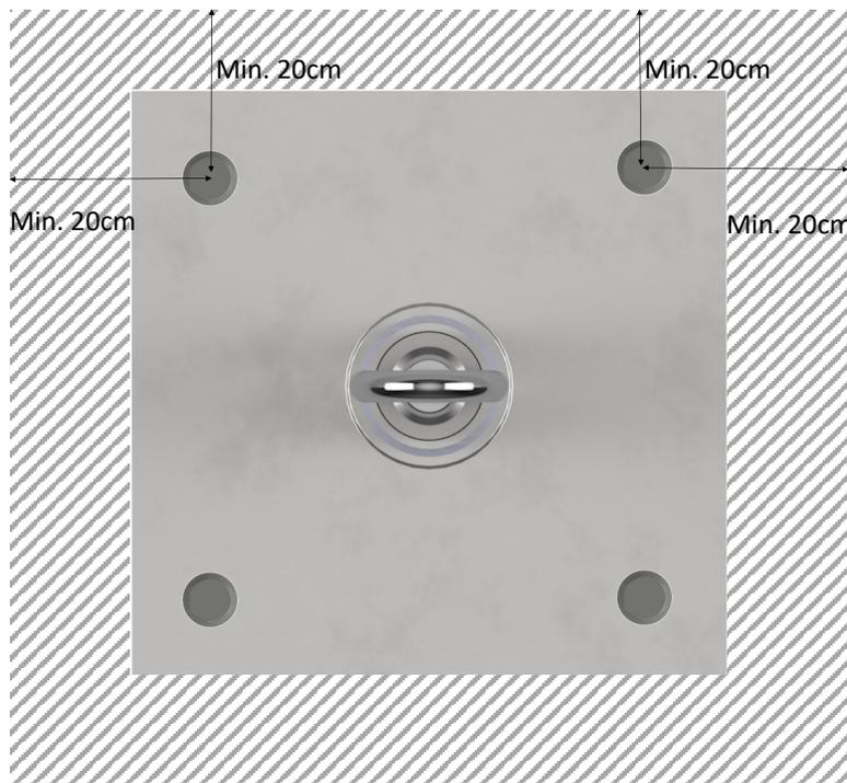
Die Anschlagereinrichtung ist generell in einem Abstand von mindestens 2,5 m zur Absturzkante zu montieren. Der Abstand der Anschlagereinrichtungen darf 15m bei Seilsystemen nicht überschreiten. Bei Einzelanschlagspunkten sollte der Abstand zwischen den Anschlagereinrichtungen 7,5m nicht übersteigen.
