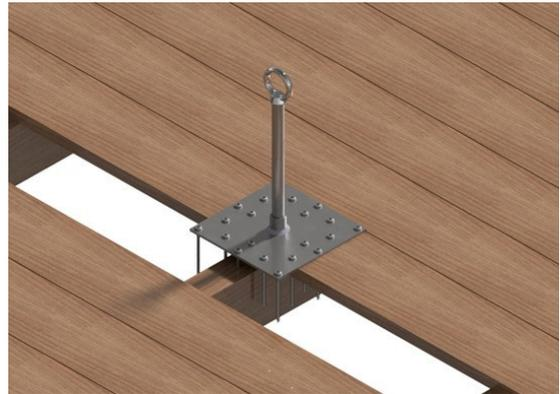
Es ist darauf zu achten, dass die Anschlagereinrichtung mittig über dem Holzbalken platziert wird, so dass 4 Schrauben in den Balken eingeschraubt werden können.
