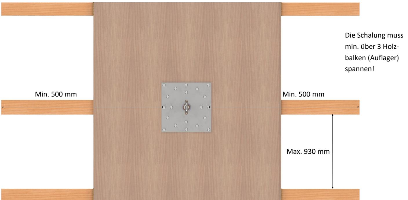
Die Anschlagereinrichtung sollte grundsätzlich gemäß DGUV Regel 112-056 in einem Abstand von mindestens 2,5 m zur Absturzkante montiert werden. Der Abstand zwischen den Anschlagereinrichtungen darf bei Seilsystemen 10 m nicht überschreiten. Bei Einzelanschlagpunkten sollte der Abstand zwischen den Anschlagereinrichtungen 7,5 m nicht übersteigen.
