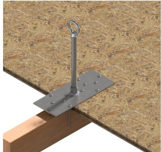
Die mitgelieferten Tellerkopfschrauben mit einem Akkuschrauber durch die vorgefertigten Löcher einschrauben. Bitte verwenden Sie einen Torxkopf TX 25.
