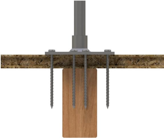
Die Anschlagereinrichtung mittig auf dem mittleren Balken platzieren. Es ist darauf zu achten, dass 8 Schrauben mittig in den Holzbalken geschraubt werden können.
