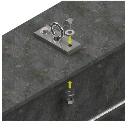
Setzen Sie nun die 2 Maschinenschrauben M12 A2-50 mit Unterlegscheibe durch die vorgegebenen Löcher ein. Auf der gegenüberliegenden Seite setzen Sie die Sechskantmutter mit Unterlegscheibe auf und ziehen diese fest.
