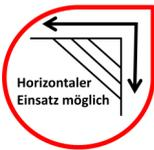
Dieses Produkt ist für einen Sturz über eine Kante und den daraus resultierenden horizontalen Einsatz in Kombination mit dem Bandfalldämpfer BFD der Sicherheitskonzepte Breuer GmbH zugelassen. Der Bandfalldämpfer ist bei einigen Varianten fest am Verbindungsmittel vernäht und somit bereits im System integriert.
