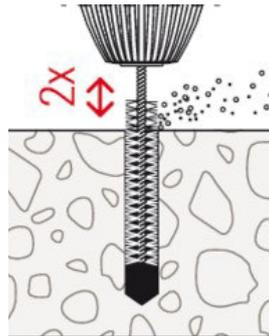
Die Bohrlöcher sind mit der Reinigungsbürste 2 mal auszubürsten.
