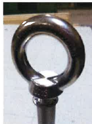
Bild 2: Ringöse der Anschlagereinrichtung, Typ: Primo 25 HU
